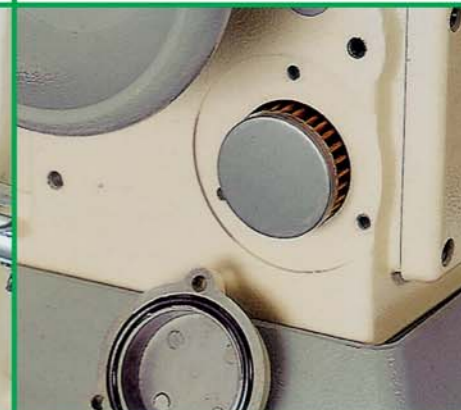
全自动供油系统，精密过滤器装置。 Automated oil feeder precision filter.
